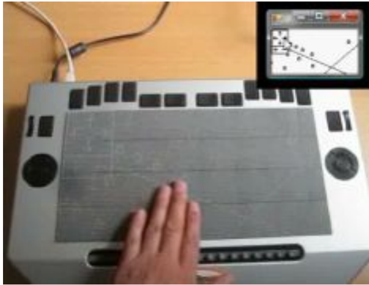
Abbildung 4: Interaktive Karten- und Routen-Darstellungen werden für die Pin-Matrix-Repräsentation aufbereitet und taktil ausgegeben
